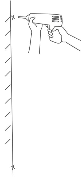
3、将2个直径为8mm的膨胀螺栓打入墙面,拧紧螺母将挂墙支架固定在墙面上。
